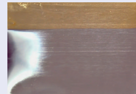
Standard Size 標準サイズ vs Tenori Size てのりサイズ. Result of Pd-Co Plating Test (Photo provided by EEJA : Palladex PC-100) パラジウム - コバルトめっき結果 (写真提供 : EEJA パラデックス PC-100)
